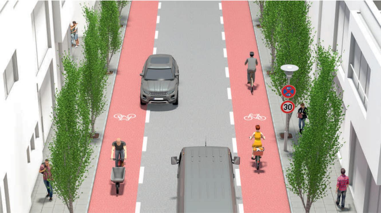
**Schutzstreifen sind ein Teil der Fahrbahn, der durch eine unterbrochene Trennlinie gekennzeichnet ist. Zusätzlich werden sie mit Fahrradpiktogrammen gekennzeichnet. Parken ist auf Schutzstreifen für Kraftfahrzeuge verboten, Überfahren und Halten auf den Schutzstreifen sind bei Bedarf zulässig. Radfahrende dürfen dabei aber nicht gefährdet werden. Für Schutzstreifen besteht keine Benutzungspflicht. Das Fahren auf dem Schutzstreifen ergibt sich aus dem Rechtsfahrgebot.**
