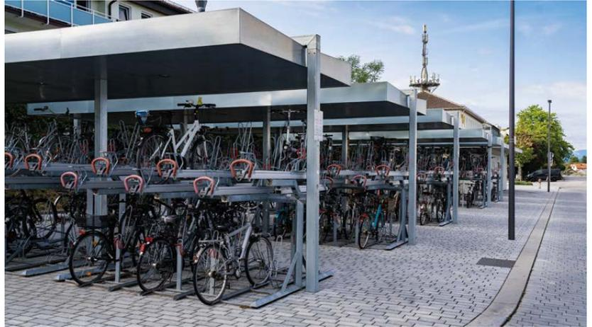
leicht bedienen lassen. Das verwendete Modell Easylift 500 D ist einer von derzeit nur drei Doppelstockparkern mit Zertifizierung nach der 2016 eingeführten DIN 79008. Im Gegensatz zu älteren Prüfsiegeln hat diese DIN hohe Anforderungen an die Handhabung von Doppelstockparkern. Das ist besonders wichtig angesichts des stetig steigenden Marktanteils von Elektro-
