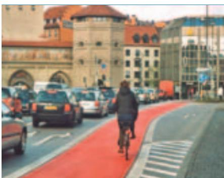
Direkt geführte Radverkehrsfurt an einem hoch belasteten Knotenpunkt
