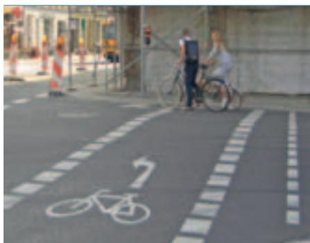
Indirektes Linksabbiegen mit Aufstellfläche und speziellem Signal für den Radverkehr
