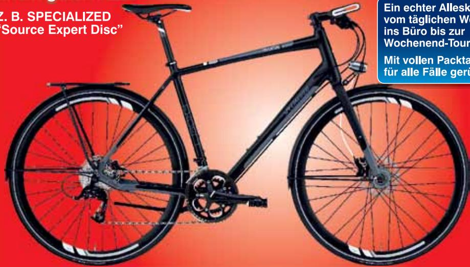
Mit integrierter Beleuchtung, Gepäckträger und Schutzblechen, mit Allwettertauglichen Scheibenbremsen plus FSA/SRAM Apex 2x10fach-Antrieb für geringeres Gewicht und perfekte Schaltperformance. Komplett neuer, superleichter Rahmen aus belastungsgerecht geformten E5 Aluminiumrohren, hydraulische Avid-Scheibenbremsen für zuverlässige Brems-Performance unter jeglichen Bedingungen und bei jeder Zuladung!
